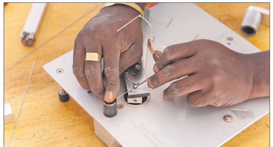
▲ Die Brillengestelle entstehen mit Hilfe einer einfachen Biegemaschine. Rund 220 Arbeitsplätze hat das Projekt so geschaffen. Fotos (2): EinDollarBrille e.V.
