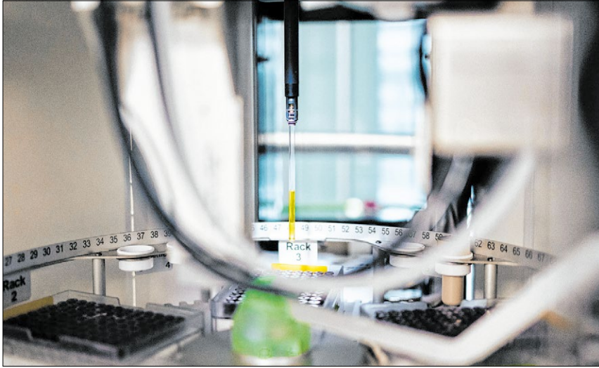
▲ Automatisierte Kernspinresonanzspektroskopie (NMR) für die Hochdurchsatz-Digitalisierung von menschlichen Metabolomen. Foto: obx-news/lifespın GmbH Regensburg
