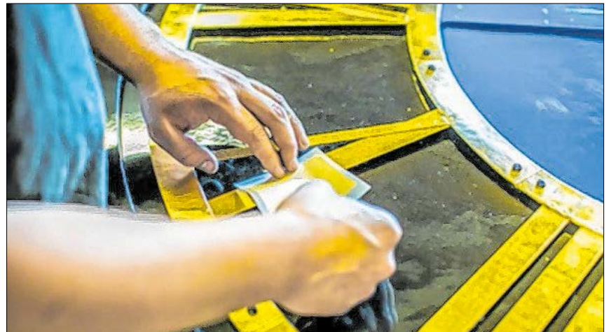
▲ Die Ziffern der Kirchturmuhren der Firma Philipp Hörz werden mit Blattgold veredelt. Foto: oh
