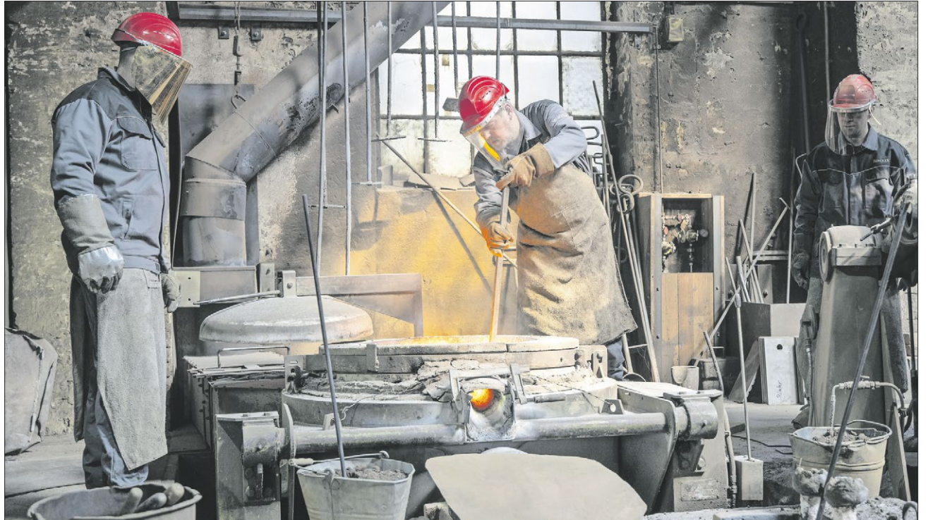
▲ Arbeiter mit Helm und Gesichtsschutz arbeiten bei der Produktion einer Glocke am Schmelzofen.
