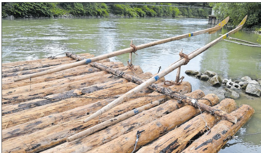
▲ Das aus geschäpsten Fichtenholzstämmen gebaute Floß ist fahrbereit.
