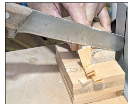
▲ Mit einem alten Küchenmesser in einer Führung werden kleine Schindeln für Dächer geschnitten.
