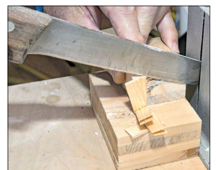
▲ Mit einem alten Küchenmesser in einer Führung werden kleine Schindeln für Dächer geschnitten.
