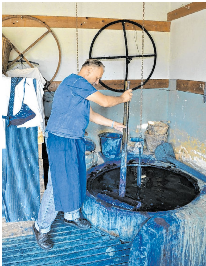
▲ Der Blaudrucker verteilt Indigo-Lösung auf die untergetauchten Stoffe.
