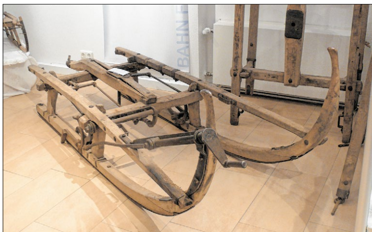
◀ Allerlei Schlittenkonstruktionen zeigen die Vielfalt des winterlichen Gefährts. Im Bild rechts: ein schwerer Baumschlitten – nicht für das Freizeitvergnügen gebaut, sondern für den Holztransport in den Bergen.
