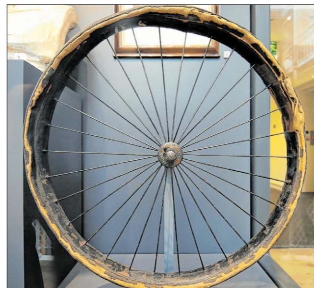
Geräuscharm, federnd und fast schon modern: John Dunlops erster Reifen ist im schottischen Nationalmuseum in Edinburgh ausgestellt. Aus Gummipfannen klebte Dunlop Schläuche, die er mit einer Fußballpumpe aufpumpte.
