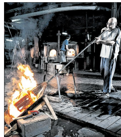
▲ Der Auftrag für den Big Ben umfasste rund 1300 Scheiben, die Mitarbeiter in der Traditionsglashütte Lamberts in Waldsassen von Hand fertigten.
