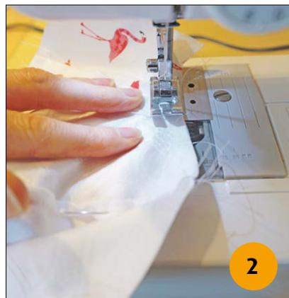
▲ Die beiden Stoffteile werden rechts auf rechts zusammengenäht.
